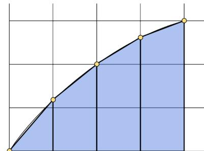
Zur Berechnung zerschneidet man nun die Kurve in Streifen mit einer Breite von  $d$ , genau bei den Messpunkten. Multipliziert man alle Kraftmessungen mit der Strecke  $d$  zwischen den Messpunkten, erhält man die Fläche in der obigen Grafik links oben. Vereinfacht rechnet
