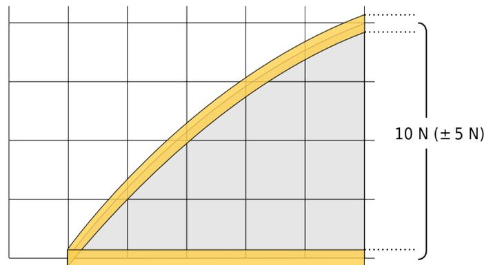
Das ergibt für einen Auszug von 0,7 m und eine Standhöhe von 0,1 m einen Fehler von  $\mathcal{F}_E = 10 \text{ N} \cdot 0,6 \text{ m} = 6 \text{ J}$ . Bei einer gespeicherten Energie von  $E = 75 \text{ J}$  ergibt das eine Messabweichung von immerhin  $f = \mathcal{F}_E/E = 8 \%$ .
